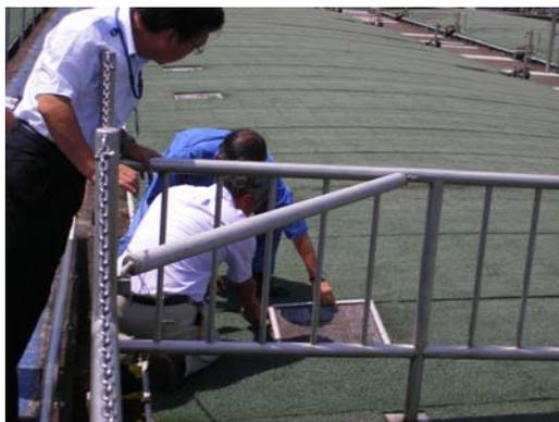
反応タンク内のCO2濃度を測定する様子
